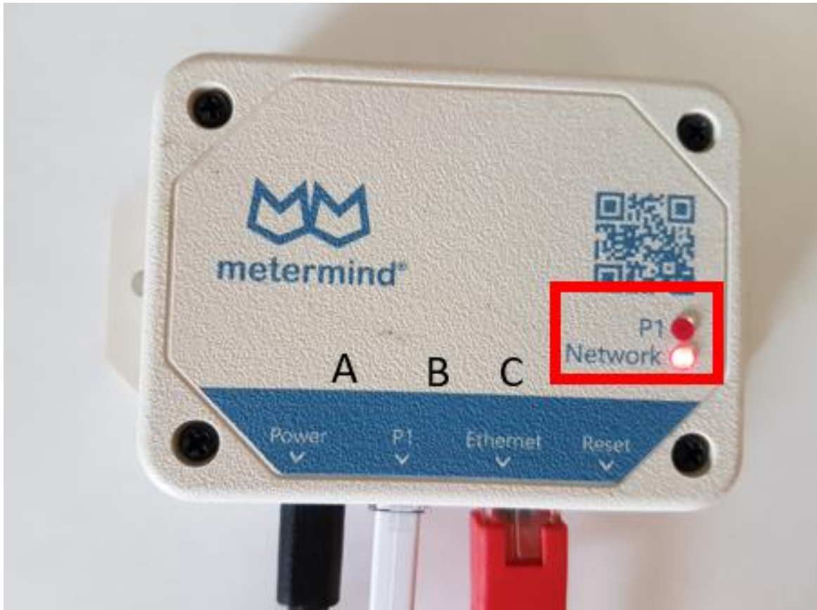
Figuur 5, Metermind aangesloten en gereed om te koppelen
