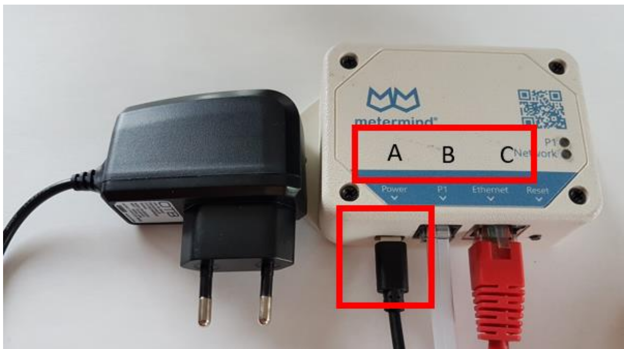
Figuur 4, Steek de stekker van de voedingskabel in poort A
